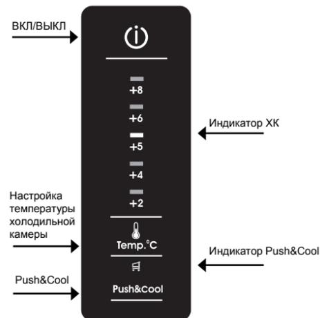
**ВКЛ/ВЫКЛ** - нажатием данной кнопки можно включить весь прибор в целом (как холодильную, так и морозильную камеру). Для отключения холодильника достаточно нажать кнопку.
