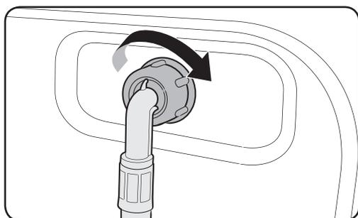
7. Подсоедините другой конец шланга подачи воды к впускному клапану, расположенному на задней стенке стиральной машины. Заверните шланг по часовой стрелке до упора.
