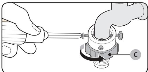
4. Вставьте адаптер в водопроводный кран и затяните винты, поднимая адаптер вверх.
