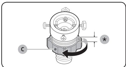
3. Возьмитесь за адаптер и поверните его часть (С) в указанном стрелкой направлении, вывинтив его на 5 мм (\*).
