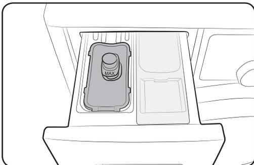
Если вы хотите использовать жидкое моющее средство, поместите поставляемый в комплекте дозатор жидких моющих веществ (A) в отсек для моющих средств, используемых в ходе **основного цикла стирки II**.
