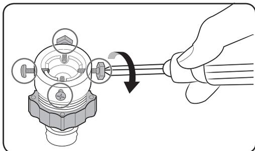
2. С помощью крестообразной отвертки ослабьте четыре винта на адаптере.
