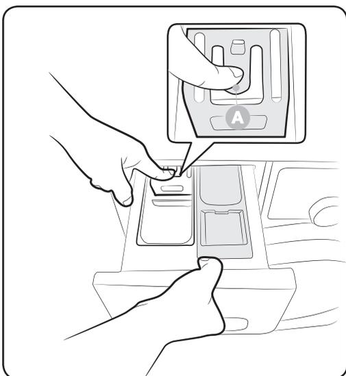
1. Нажмите **освобождающий рычаг (A)**, расположенный внутри ящичка для моющих средств, и извлеките ящичек.
