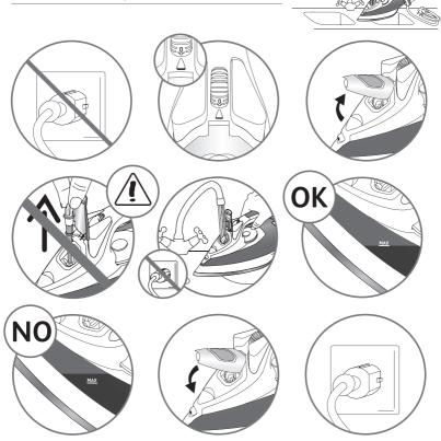
\*CS Naplnění vodní nádržky • HU Víztartály feltöltése • SK Naplnenie vodnej nádržky • HR Otvor za punjenje spremnika vode • SL Polnjenje rezervoarja • RO Umplere rezervor de apă • SR Punjenje rezervoara za vodu • BG Пълнене на резервоара с вода • PL Napełnianie zbiornika • TR Su haznesini doldurma • UK Наповніть резервуар водою • ET veepaagi täitmine • LV Ūdens tvertnes uzpildīšana • LT Vandens talpos pildymas • RU Заполнение резервуара для воды
