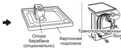
Снимите транспортировочные болты и опоры.
