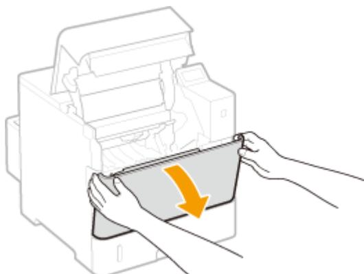
**4** Снимите крышку устройства подачи конвертов.
