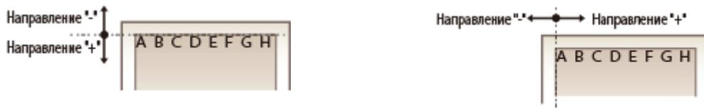
В показанном ниже примере для сдвига положения печати на 5 мм вверх и на 1,7 мм вправо задается значение «-5,0 мм» в поле <Смещение Y> и значение «+1,70 мм» в поле <Смещение X>.
