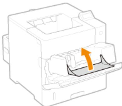
**2** Снимите устройство подачи конвертов.
