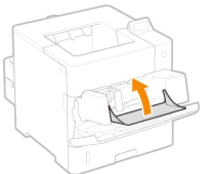
**2** Снимите устройство подачи конвертов.
