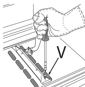
5. Вывинтите жиклер горелки при помощи специального торцевого ключа для жиклеров, или, что предпочтительнее, торцевым ключом на 7 мм, и замените его жиклером, пригодным для нового типа газа (см. Таблицу 1).
