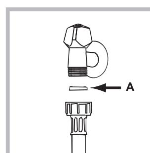
1. Вставьте прокладку А в конец заливного шланга и наверните его на вывод водопровода холодной воды с резьбовым отверстием 3/4 дюйма (см. рис.).
