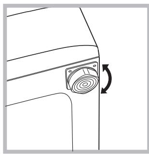
Належне вирівнювання надає стабільність машині та запобігає вібрації, шуму та пересуванню під час роботи. При встановленні машини на килимовому покрівлі або килимі відрегулюйте ніжки таким чином, щоб залишити під пральною машину достатній простір для вентиляції.
