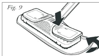
Чтобы снова снять насадку для пола, нажмите соответствующую кнопку разблокировки (см. рис. 7) и вытащите насадку.
