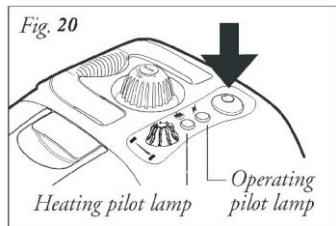
Должна загораться зеленый индикатор подключения сети и красный индикатор нагрева воды (рис.20). Индикатор сети горит, как во время подключения к сети. Контрольный индикатор нагрева указывает, что вода в настоящее время нагревается. Рабочая температура достигается в течение приблизительно 11 минут. После этого красный индикатор погаснет. Прибор готов к использованию.
