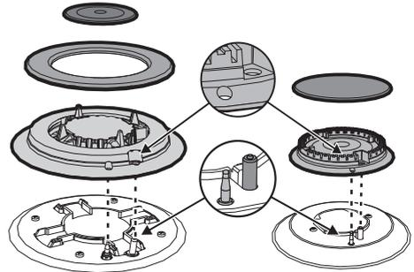
2. Sostituire gli ugelli tramite una chiave a tubo da 7 mm secondo il gas da
