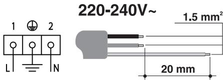
Cavo **tripolare 3 x 1,5 mm<sup>2</sup>**.
