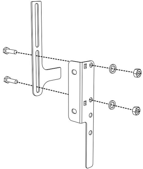
4. Allineare la base del gancio della staffa di fissaggio con la base del taglio della piastrina di fissaggio al muro.
