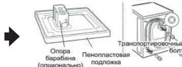
Снимите транспортировочные болты и опоры.
