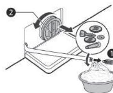
**4** После очистки фильтра сливного насоса выньте его и вставьте сливную пробку.
