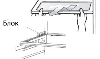
2. Извлеките выдвижной ящик & для хранения овощей и фруктов, потянув его вперед. Придерживая выдвижной ящик одной рукой, немножко приподнимите его и извлеките из холодильника.
