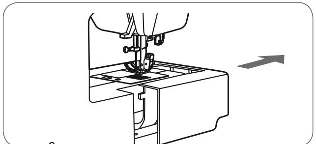
Передвиньте рычаг в положение (a), чтобы поднять транспортер.
