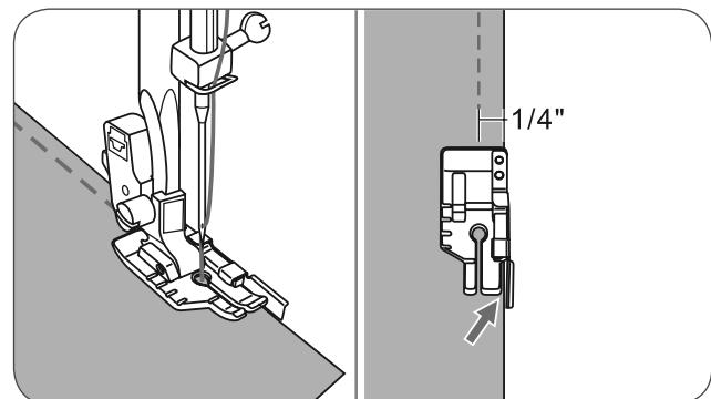
Внутренняя часть лапки служит кромконаправителем 1/8" (4 мм)
