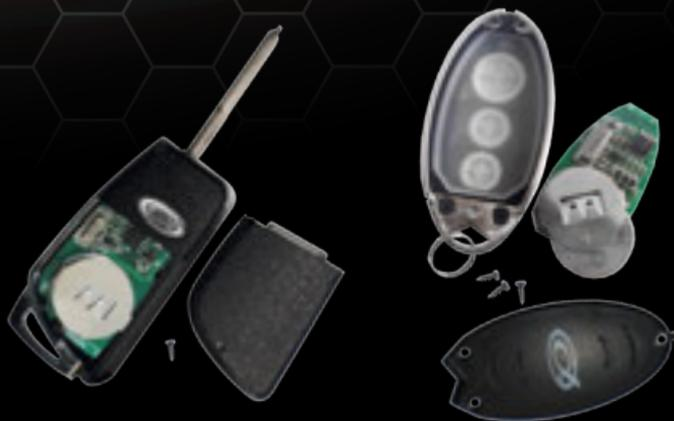
Выкрутите саморез(ы) на задней части брелока при помощи фигурной отвертки, разберите корпус, замените элементы питания (3 элемента CR 2016) на плате брелока.
