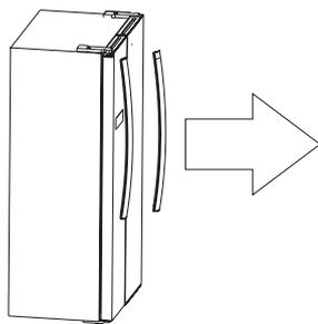
2. Потяните ручки, чтобы снять их.
