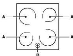
А. Зоны нагрева с радиальными нагревательными элементами.
