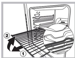
**ВНИМАНИЕ** □ Духовый шкаф укомплектован системой блокировки решеток, позволяющей вынимать их из духовки не полностью (1).
