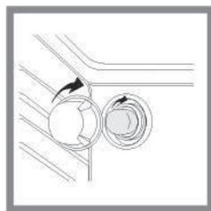
1. Отключите оборудование от электросети, затем снимите стеклянный плафон с патрона лампы (см. рис.).
