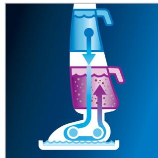
Благодаря раздельным резервуарам для чистой и грязной воды очистка пола осуществляется только чистой водой. Вся грязь и аллергены остаются в резервуаре для грязной воды.
